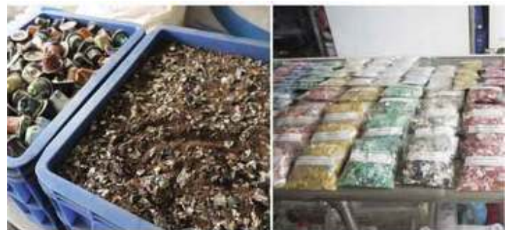
【左】「ネスプレッソ」の使用済みコーヒーカプセルをアルミニウムとコーヒーに分けて再資源化する工程【右】色別に分けた廃プラスチックを洗浄・粉碎したフレーク＝6月18日、タイ・ピサヌローク県（NNA撮影）
